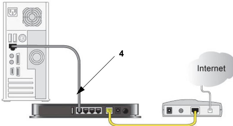
ケーブルの接続が完了し、ネットワークに接続する準備ができました。最初にモデムの電源をオンにし、モデムが起動したらルーターの電源をオンにします。
