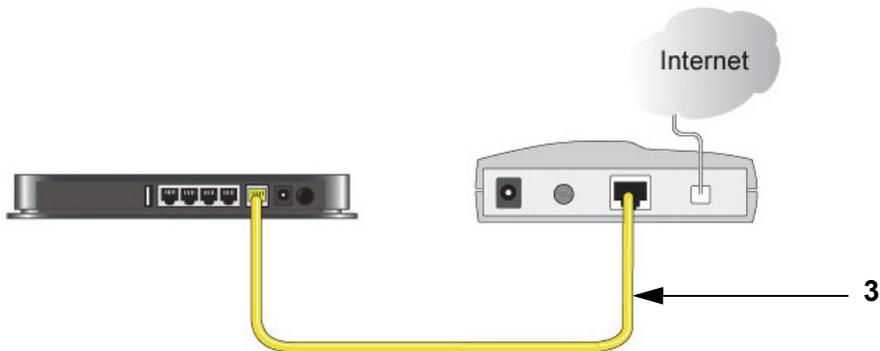
5. 手順3でモデム側から外したケーブルをルーターの LAN ポート 1～4 のうちどれかに差し込みます。(4)
