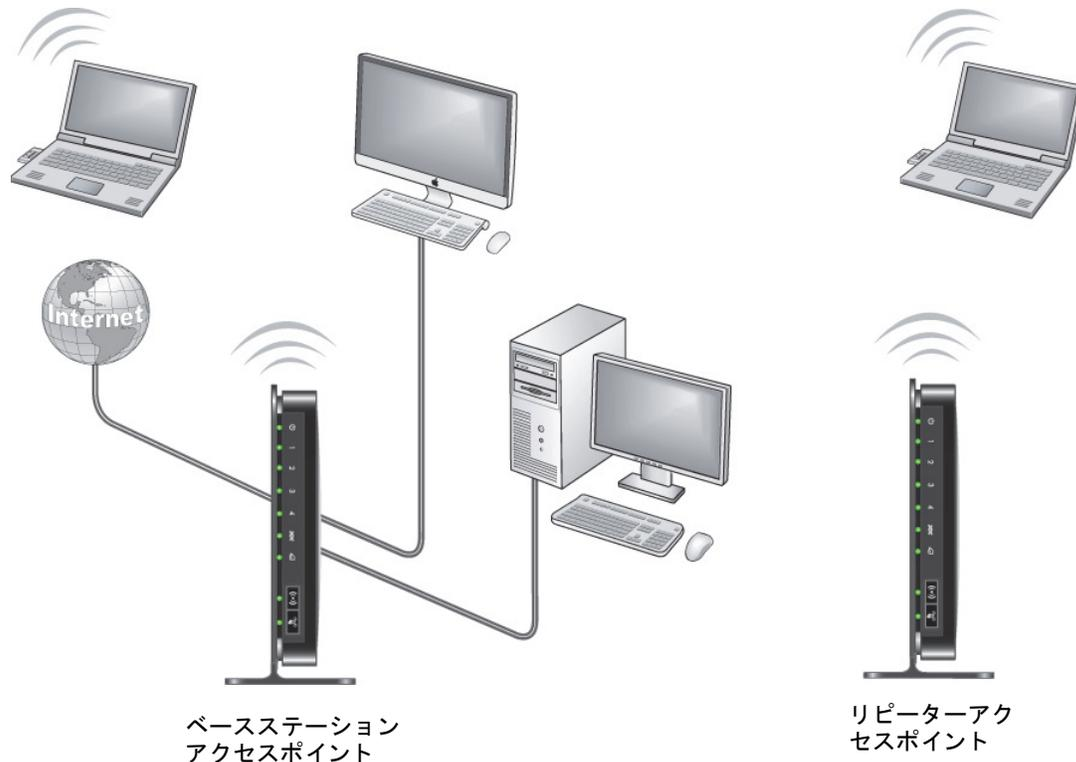
図 7. ワイヤレスリピーターの使用例
