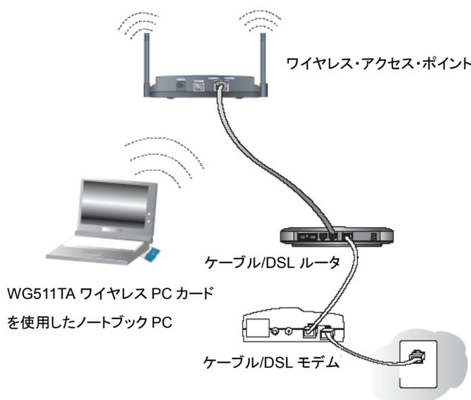
図 4-1: ワイヤレス・アクセス・ポイントに接続している WG511TA ワイヤレス PC カード
