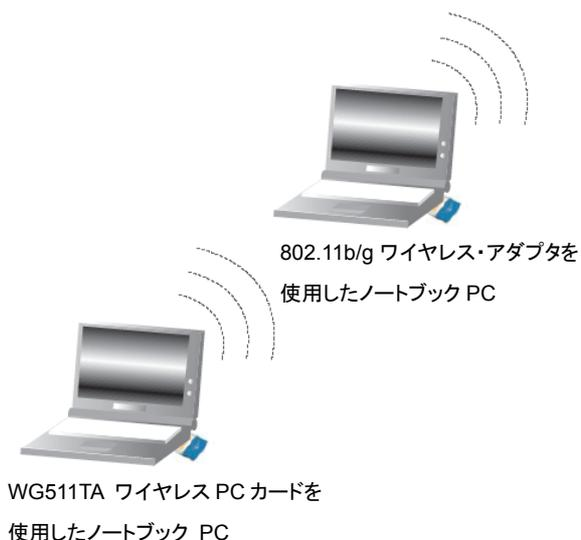
図 4-3: ピア・ツー・ピア・モードの NETGEAR WG511TA ワイヤレス PC カード
