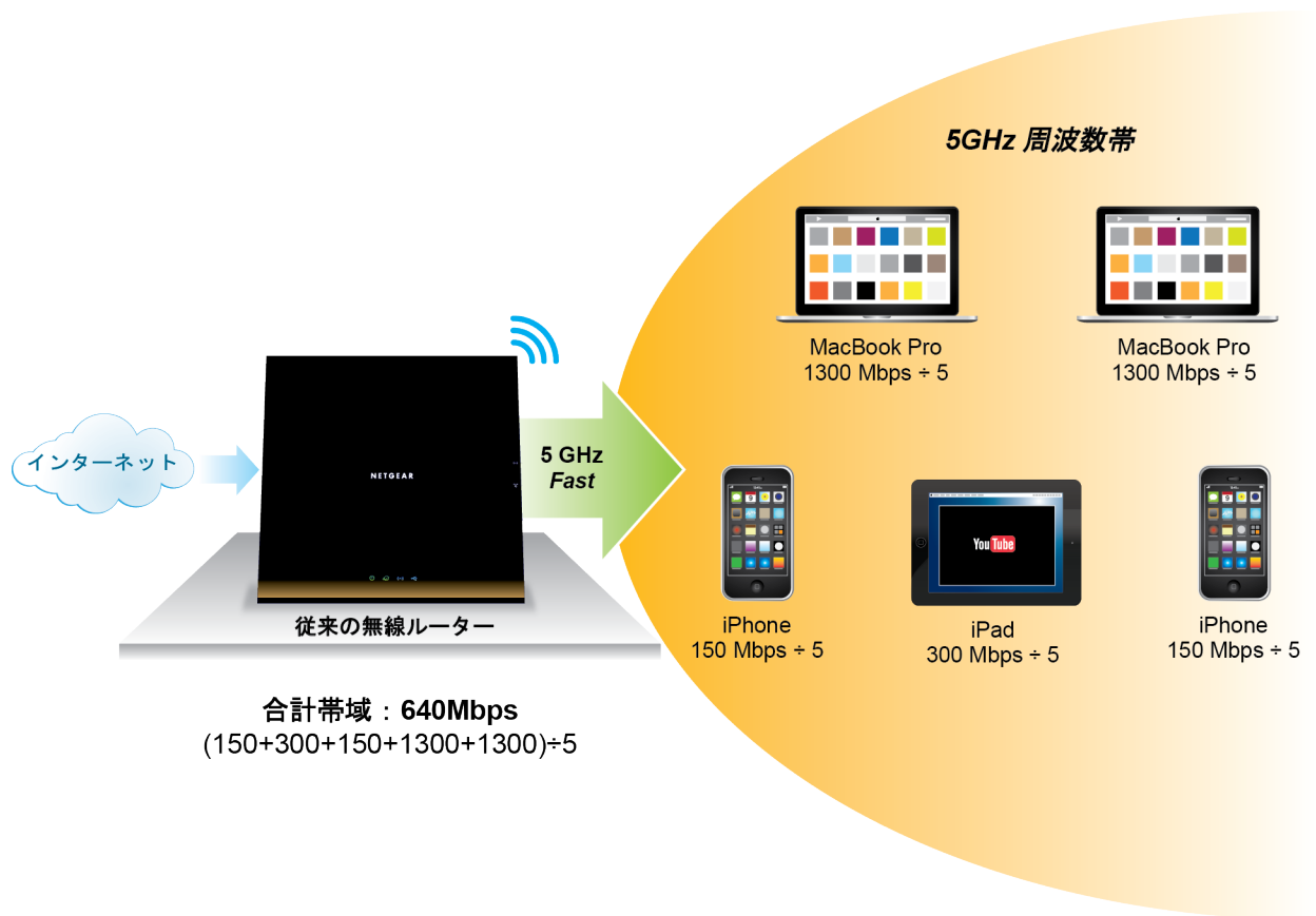
図 7：1つの5 GHz帯を使用するデュアルバンド無線LANネットワーク
