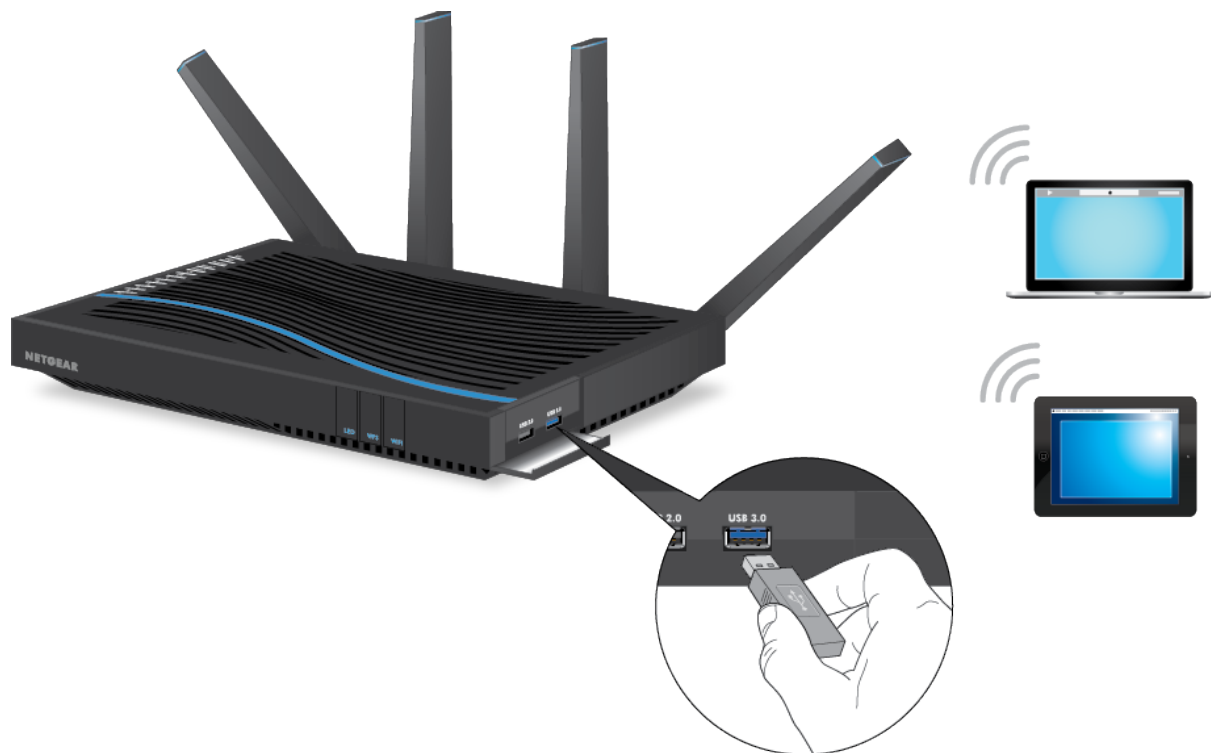
図 3 : USB 3.0ポートとUSB 2.0ポートが右側にある
