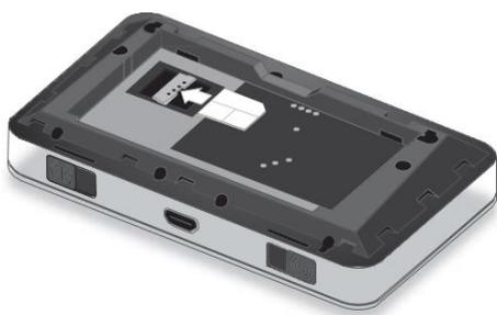
4. バッテリーを取り付けます。図のように、バッテリーと本体の金色の接点同士が接触するように挿入します。
