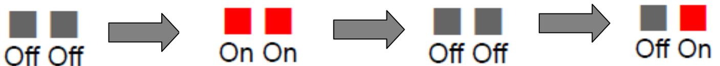
7. リセットボタンを3秒間押し続けます。すると、最下部の2つのLEDが左右同時に2度赤く点滅します。
