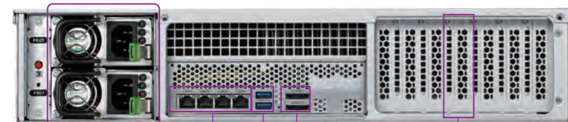
電源ユニット×2(交換可能) 1000BASE-T×4 eSATA×2 拡張スロット×1
