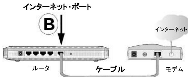
図 3-2: Ethernet ケーブルをワイヤレス・ルータに接続する
