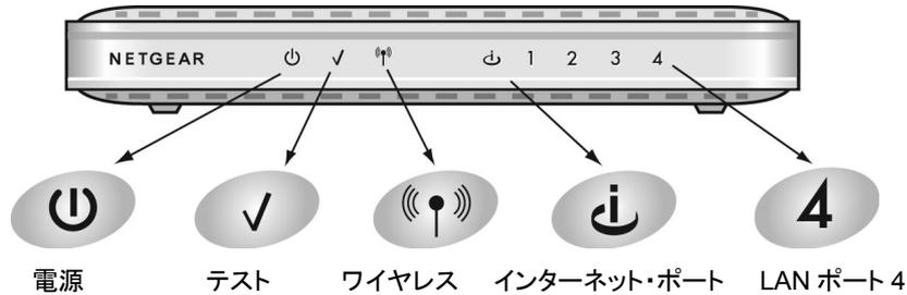
図 3-4: ステータス LED で接続を確認する
