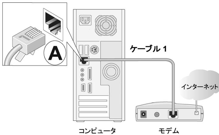
図 3-1: コンピュータから Ethernet ケーブルを外す
