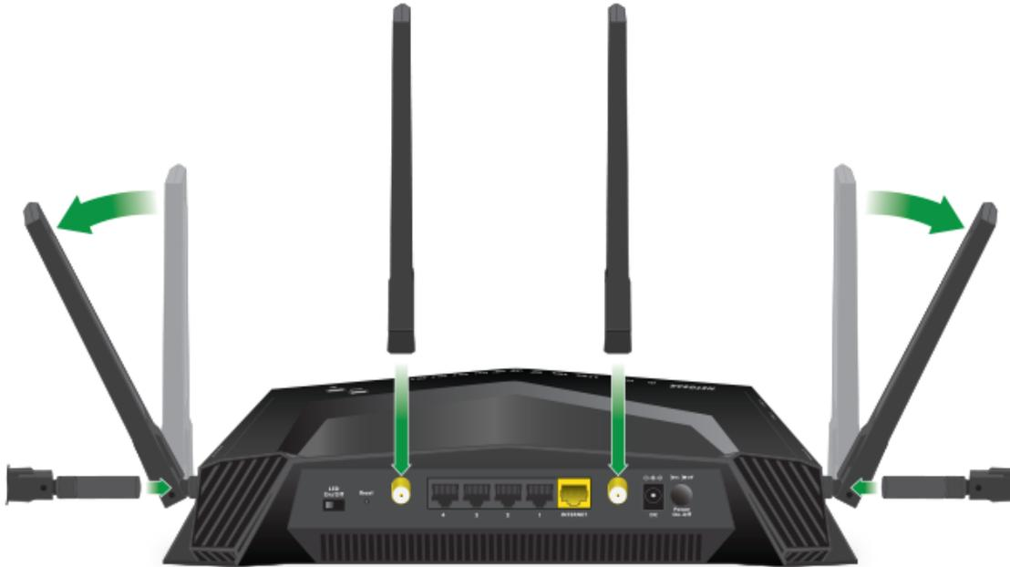
図4: アンテナを接続し、無線LANのパフォーマンスが最大になるように位置を調整します。
