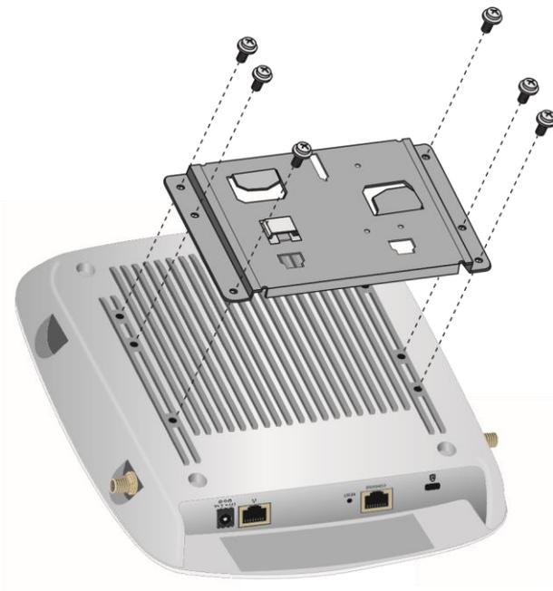
2. 天井のレールがアクセスポイントマウンティングブラケットの2つのタブの間に入るようにアクセスポイントを合わせます。
