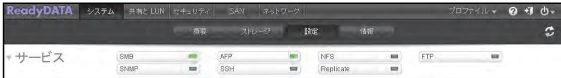
緑色の LED が表示されたプロトコルボタンはグローバルで有効になっています。黒い LED が表示されたものはグローバルで無効になっています。プロトコルボタンをクリックして、プロトコル設定画面を表示します。
