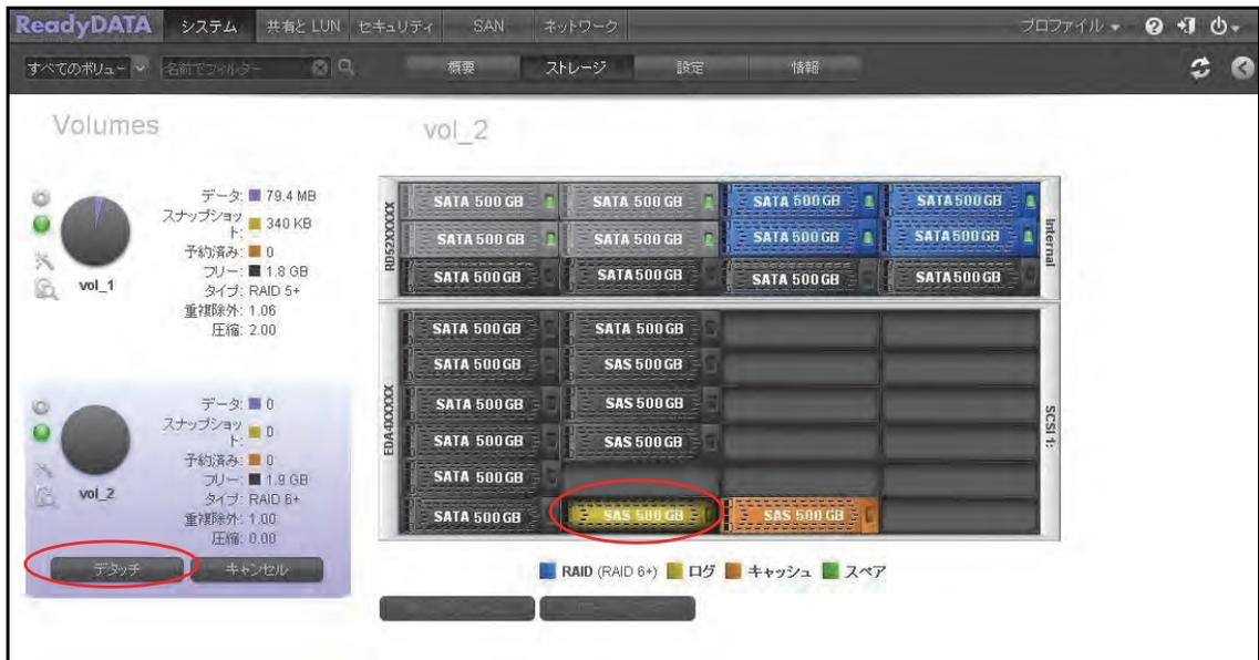
**注意:** 上の図では SAS ディスクが write boost および read boost ディスクとして使用されていますが、通常は SSD が使用されます。
