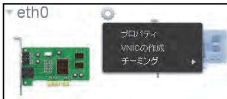
新しい VNIC がイーサネットインターフェイスの横に表示されます。新しい VNIC は、それがアタッチされているインターフェイスに関係なく、順次昇順で番号が付与されます。例えば、2 つのイーサネットインターフェイス eth0 ( デフォルトの vnic0 を有する ) と eth1 ( デフォルトの vnic1 を有する ) を備えたシステムでは、新しい VNIC が eth0 または eth1 のどちらにアタッチされているかに関係なく、新しい VNIC には vnic2 という名前が付けられます。
