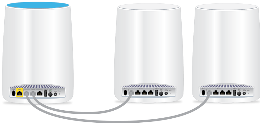
図 10：ルーターのLANポートに接続されたサテライト
