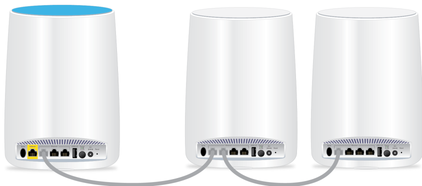
図 11 : サテライト1をルーターに接続し、サテライト2をサテライト1に接続
