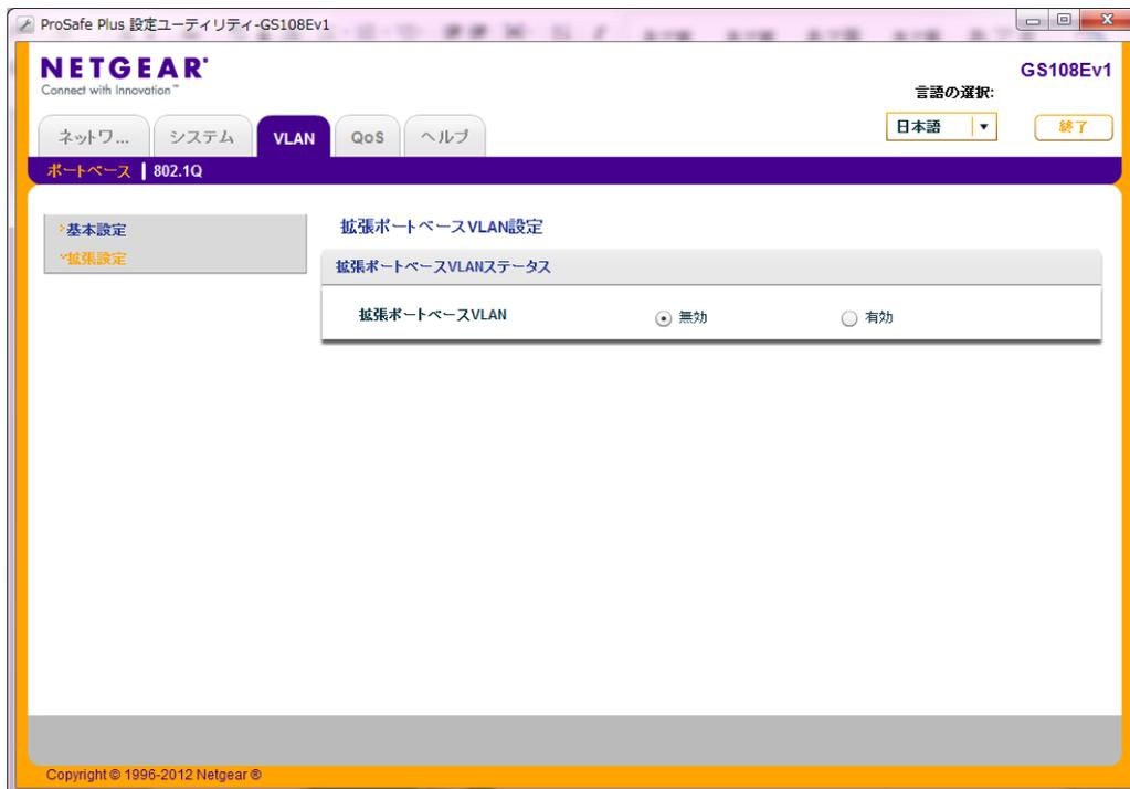
3. 「有効」を選択後、「VLAN 設定」が設定可能になりますので、A グループ用の VLAN を設定します。
