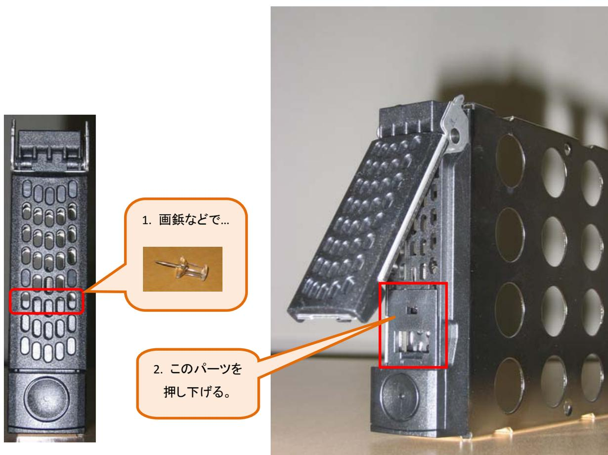
右図のように、トレイにピンを差し込みましたら、ピン全体を下に押し下げてください。すると、ラッチが外れます。
