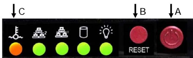
4. リセットボタンを 1 度押します。このときのリセットボタン押下後はすぐに離す事。正面右上コントロールパネル内の左端の LED が 1 回点灯する事を確認します。
